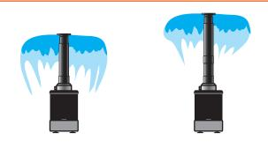
噴水の形状は、ノズル調整、水量調整、 使用場所(東日本(50Hz)は西日本(60Hz)より小さめになる)、 パイプの長さ、容器内の水深、フィルターの汚れ具合等 条件によって異なります。
