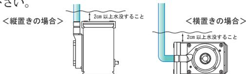
●取り付け姿勢はシャフトが水平になる向き、または吸い込み口が下向きになるよう設置してください。縦置き・横置きにかかわらず、本体全部を完全に水中に沈めてください(水面から本体上部まで 2cm 以上水没する深さを保ってください)。
