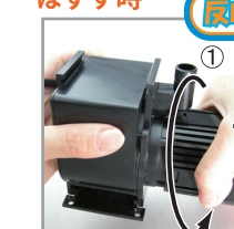
M6SP ポンプ本体とストレーナーを両手でしっかりと持ち、反時計回りにひねってから左右に引き抜くと、ストレーナーがはずれます。
