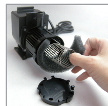
スポンジフィルターとコイル・スプリングを取り出す
